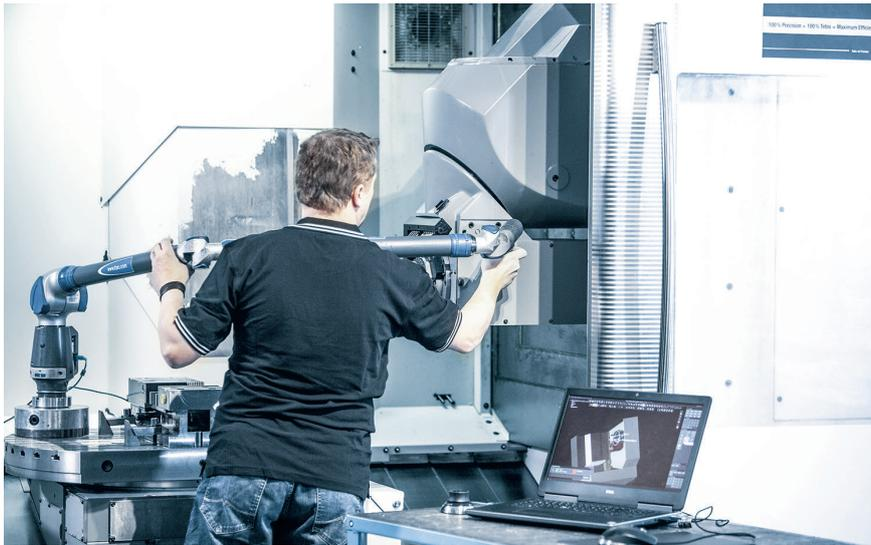
**2** Digitalisierung der Fertigungsumgebung: Detailgetreue virtuelle Abbildungen, etwa von Maschinen, Werkzeugen, Spannmitteln und Aggregaten, werden in das CAD/CAM-System Tebis mit ihren jeweiligen geometrischen und technologischen Eigenschaften integriert
